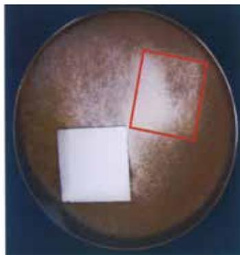
高機能性抗菌塗料焼付け塗料試験板。
